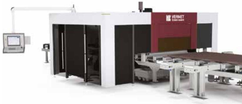
Chute en bord de tôle de 20 mm seulement grâce aux pinces repositionnables
