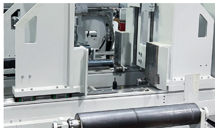
Unité de marquage - fraisage 4 ème axe Milling and marking unit on 4th-face 4-seitiges Fräsen und Markierenheit
