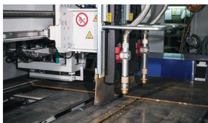
Unité de poinçonnage 3 outils et double torche plasma 3-tool punching unit and double plasma torch Stanzeinheit 3 Durchmesser und Doppelplasma Brenner
